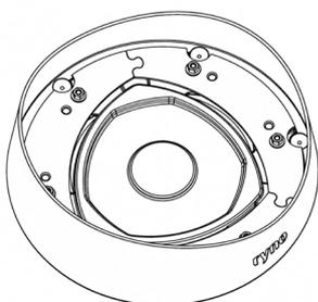
Placez les trois autres plaques de maintien sur les montants en veillant à ce qu'elles soient correctement orientées. Fixez les aux supports à l'aide des six écrous et rondelles fournis.
