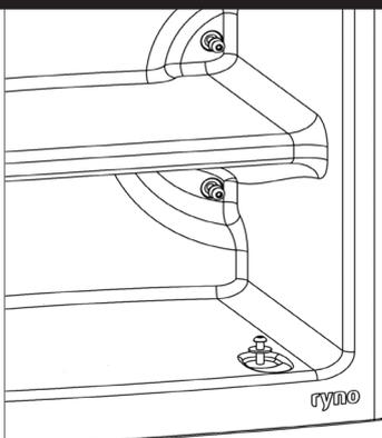
Replacer le produit et le fixer solidement au mur à l'aide des boulons et rondelles appropriés.
