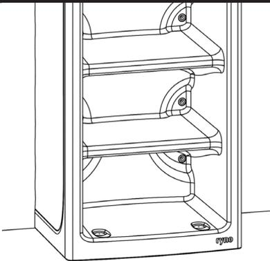
Percer à travers les 9 points de fixation arrière, ainsi que les deux points de fixation au sol (si une fixation au sol est prévue), d'abord avec une mèche bois puis, dans le mur, avec une mèche béton.
