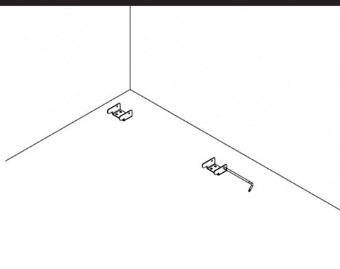
Insérer le boulon de verrouillage, orienté vers l'extérieur, dans une ou deux équerres avant (avant gauche ou avant droite) et le visser de quelques tours seulement. (Les 4 boulons de verrouillage peuvent être utilisés si seule la tête du lit est positionnée contre un mur).
