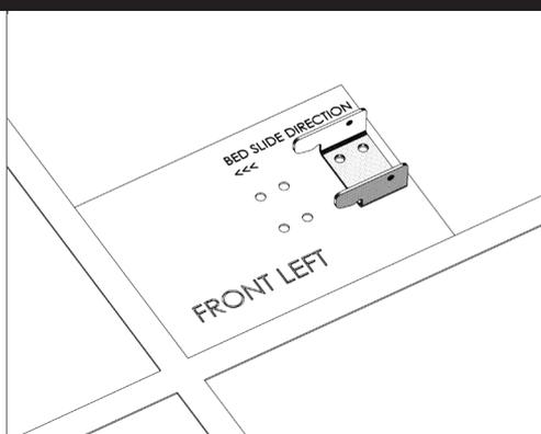
À l'aide du gabarit, marquer puis percer le sol à chaque emplacement de fixation des équerres (4 points de fixation). Prendre en compte le sens de coulissement du lit, indiqué par les flèches. (Dans cet exemple, le lit glisse sous les équerres de gauche à droite).
