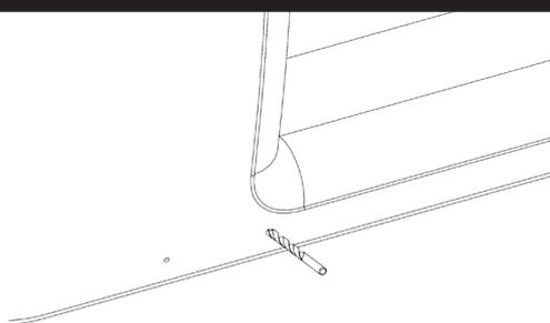
Percer le côté du lit à l'emplacement des boulons de verrouillage (foret bois 8 mm). Retirer les copeaux de plastique si nécessaire. Le trou doit correspondre au repère en creux sur le côté du lit.
