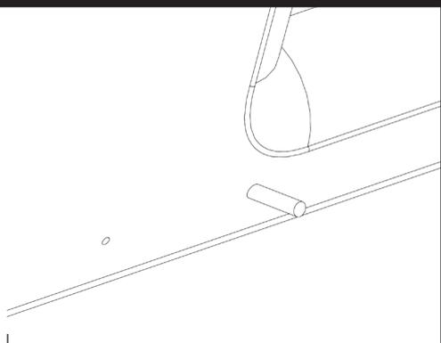
Enfoncer la tige de remplissage pour bloquer l'accès aux vis de verrouillage.
