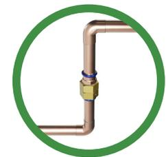
Les conduites d'eau pivotent grâce à un système breveté — aucun tuyau flexible requis.
