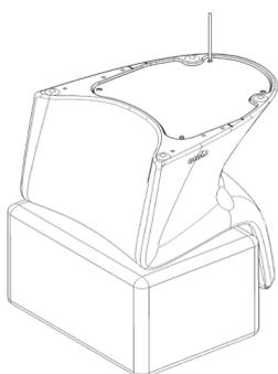
Placez la plaque de base dans l'ouverture prévue et marquez les 4 emplacements des inserts à l'aide de la pointe à tracer.
