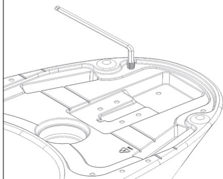
Installez les 4 inserts bois M10 à l'aide de la clé hexagonale, en veillant à ce qu'ils soient parfaitement affleurants à la surface du produit.
